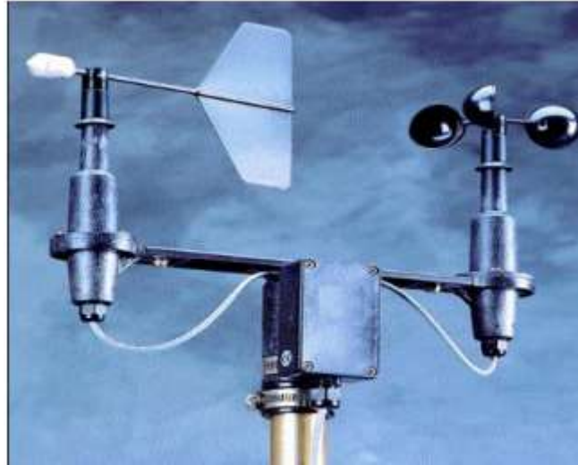
Şekil 7. Ölçüm istasyonunda kullanılan anemometre.
