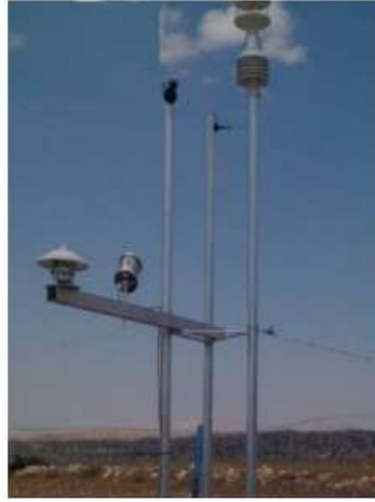
Şekil 6. Ölçüm istasyonunda kullanılan piranometre.
