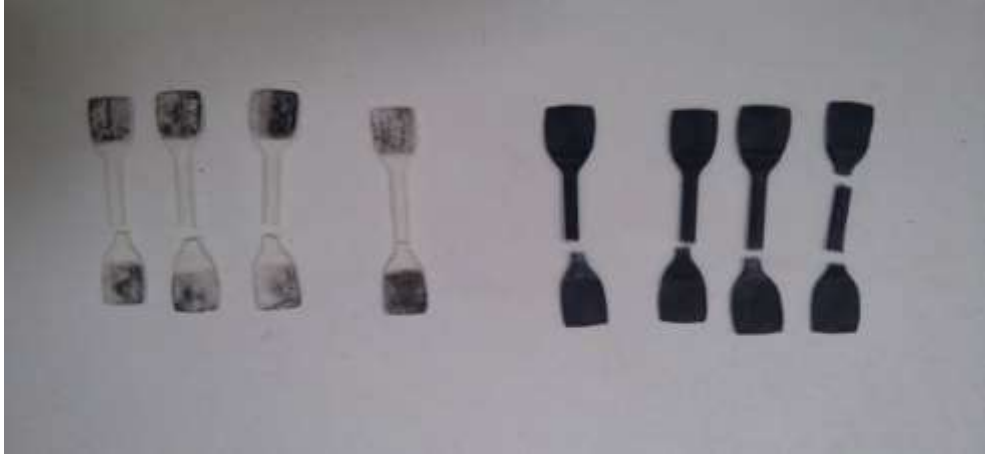
Şekil 6: Deney numunelerinin PLA/ABS çekme testleri sonucu yüzeyleri.
